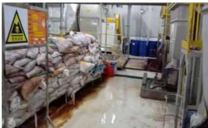
涂装车间磷化渣、漆渣暂存处
