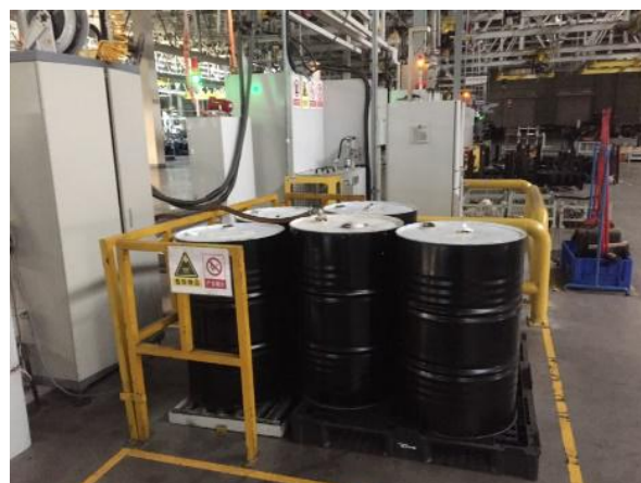
车间油料暂存点
